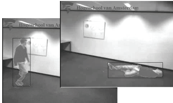
FIGUUR 3 Twee beelden uit een video waarin een val gedetecteerd wordt met bounding box
