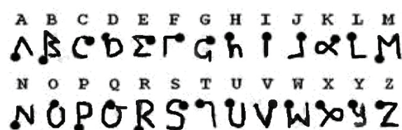
FIGUUR 3 Bij het alfabet gedefinieerde handgebaren. De bullet geeft het startpunt van het handgebaar aan
