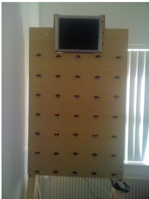
FIGUUR 1 Sensorbord voor het herkennen van handgebaren van studenten Een handgebaar wordt verkregen door de hand te bewegen voor het bord en daarmee een bepaalde sequentie sensoren te triggeren.
